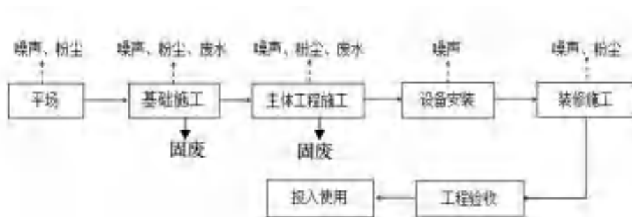
图 2-2 施工期工艺流程及排污节点图
