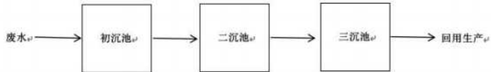
图 4-1 清洗废水处理设施工艺流程图
