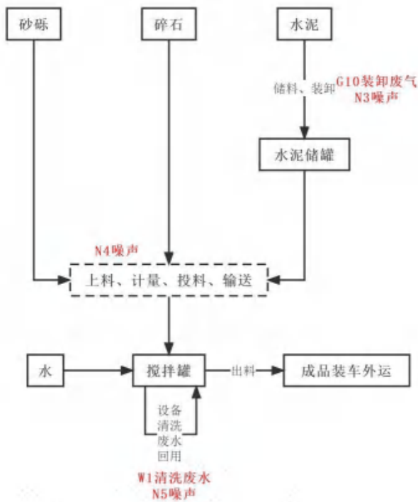
图 2-4 水泥稳定碎石料生产线生产工艺流程图及产污节点图
