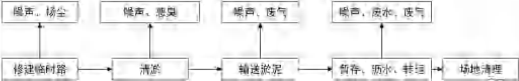
图 2-18 清淤工程施工流程及产污节点图
