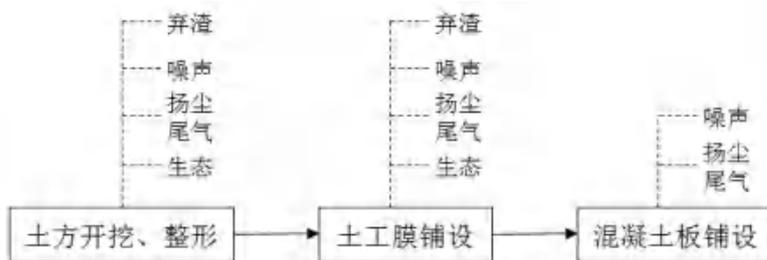
图 4.1-3 沟道施工工艺及产污环节
